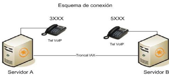
Figura 9. Ejemplo de conexión troncal con el protocolo IAX
