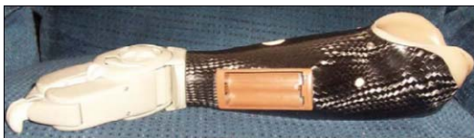
Fig. 4 Prótesis mioeléctrica con pinza en la punta.
